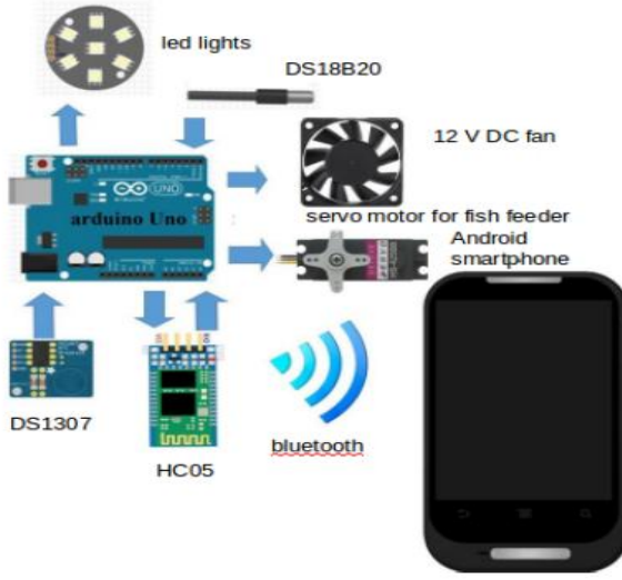
Şekil 6. Arduino ve Android'in diyagram bloğu (Yohanes, Suryadi ve Susilo, 2019)
